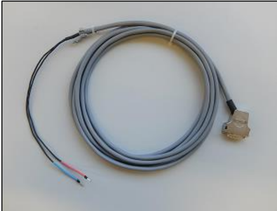
Abbildung 2-13: Leitung zur Versorgung der Servomotoren
