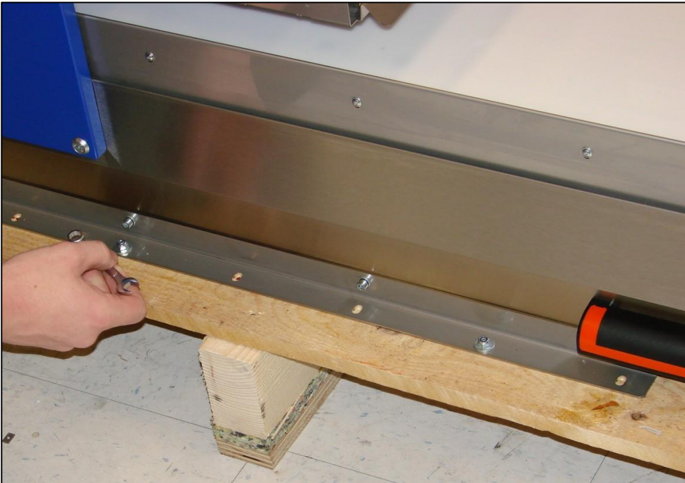
Abbildung 2-1: Schrauben für den Transport (Montageschiene)
