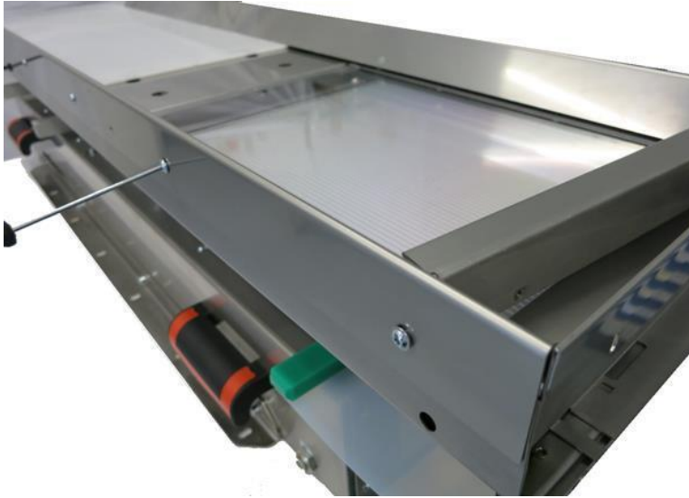
Abbildung 6-2: seitliche V-Schiene am Förderdeck
