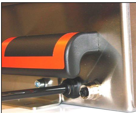
Abbildung 2-8: Pneumatikleitung mit Anschluss verbunden
